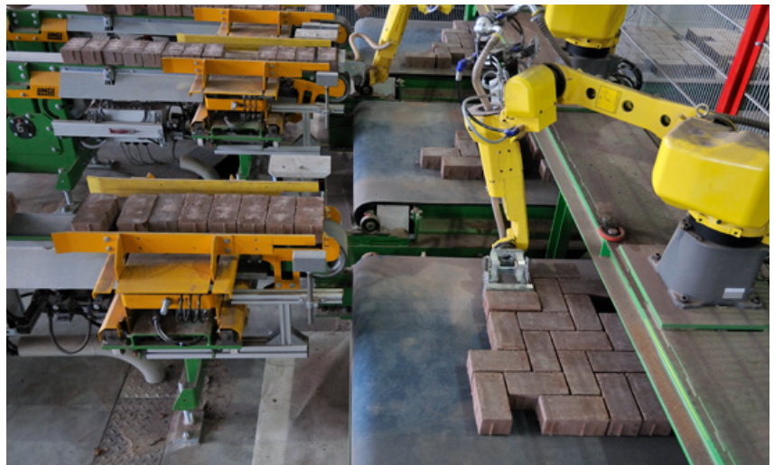
Robots leggen in de steenfabriek de baksteen alvast in het gewenste bestatingsverband
