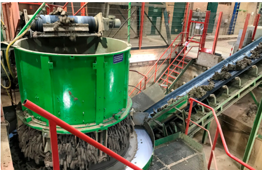
De gemengde klei wordt door een kleirasp gedrukt
