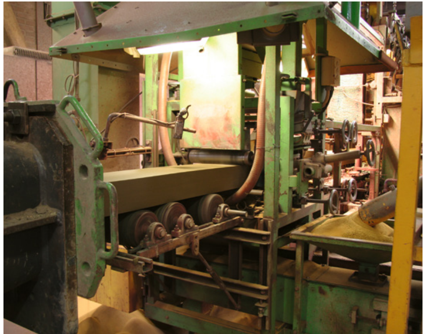
Een streng klei wordt uit een strengpersmachine geperst
