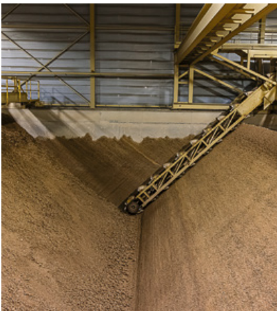
Opslag in kleikelder, klei wordt verticaal afgegraven met excavateur
