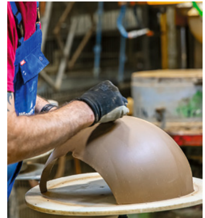
Het broekstuk is een hulpstuk voor de afwerking van de aansluiting tussen daknok en hoekkepers, of van op elkaar aansluitende daknokken
