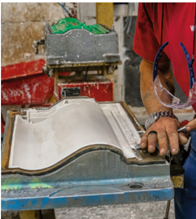
Het maken van de gipsvormen voor de stempelpers
