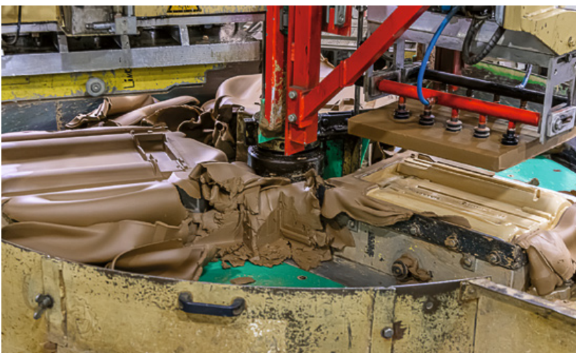
Draaitafelpers vormt de dakpan uit de kleikoeken
