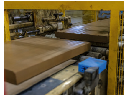
Kleikoek uit strengpers op de gewenste lengte gesneden met een snijdraad
