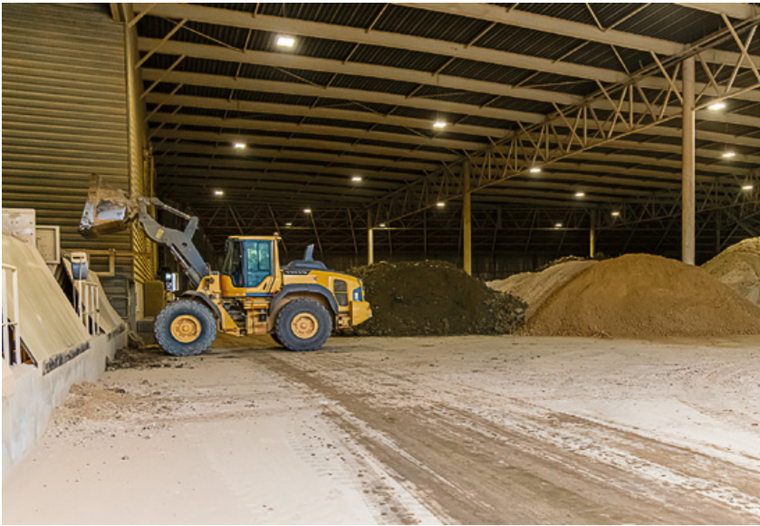
Kleiopslag in halfopen loods, de klei wordt gelost in een toevoerkast
