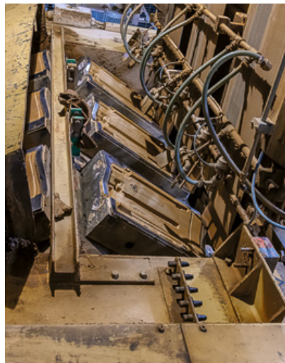
Vorming van dakpannen in een Revolverpersers
