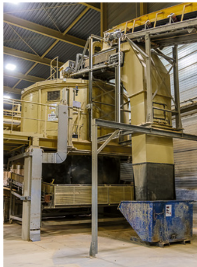
De Kollergang voor verkleining en micromenging van de klei
