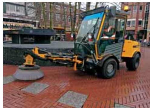
De borstelmachine wordt ingezet bij het mechanisch verwijderen van onkruid. Het is van belang dat de juiste borstels worden gebruikt ter voorkoming van beschadigingen.
