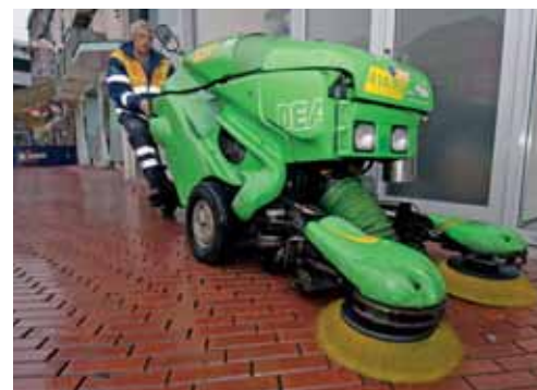
De schrobmachine wordt ingezet om vuil te verwijderen op de verharding en het aanbrengen van een filmlaag. De filmlaag geeft kauwgum en ander hechtvuil minder kans zich aan de verharding te hechten.
