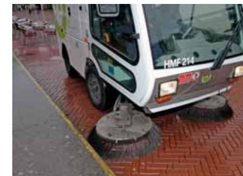
De veegmachine wordt ingezet bij het verwijderen van zwerfafval en het verwijderen van zand. Hierdoor is er minder kans dat onkruidzaden in het zand kunnen kiemen.
