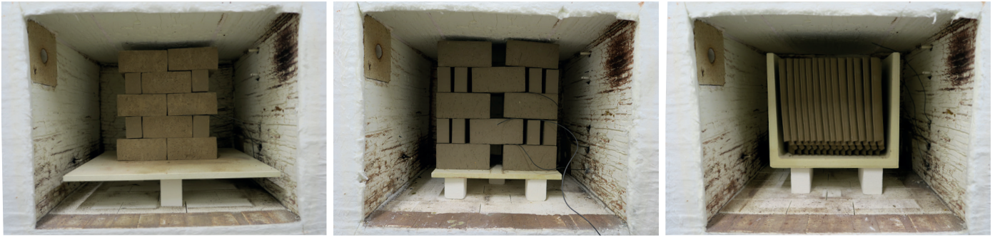
Afbeelding 2: Gehanteerde zetwijzen voor Dikformaat (DF), Waalformaat (WF) en dakpannen
